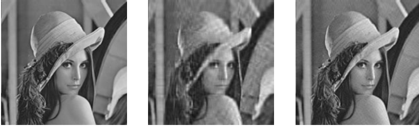
Figure 6.5. L'image originale (à gauche), celle obtenue avec les 20 premières valeurs singulières (au centre) et avec les 60 premières valeurs singulières (à droite)
